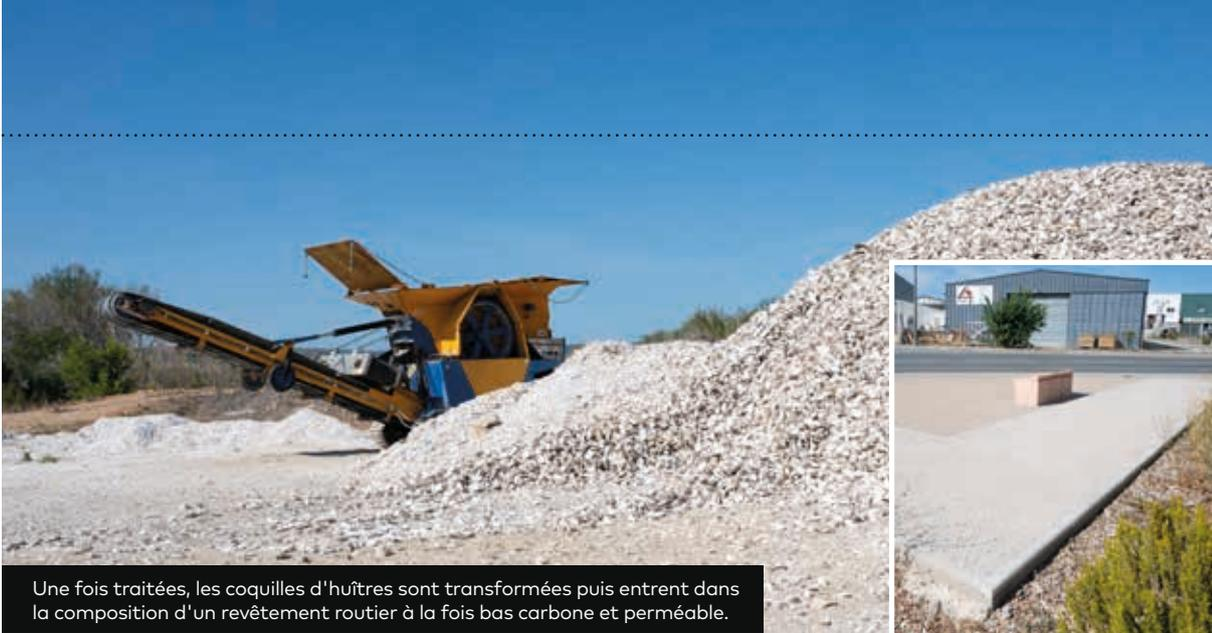
Une fois traitées, les coquilles d'huîtres sont transformées puis entrent dans la composition d'un revêtement routier à la fois bas carbone et perméable.
